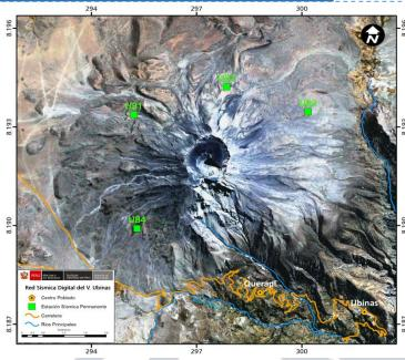
Red de 4 estaciones sísmicas del IGP. Las señales llegan hasta Arequipa en tiempo real.
