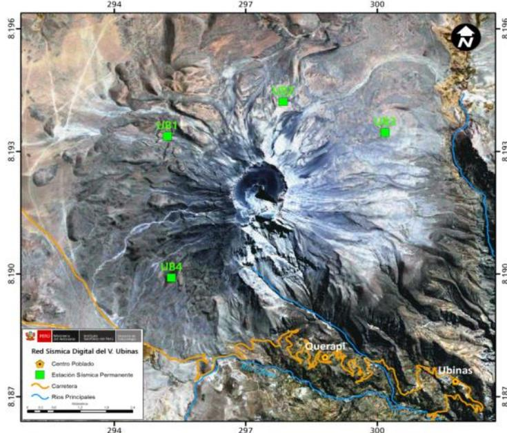
Red de 4 estaciones sísmicas del IGP. Las señales llegan hasta Arequipa en tiempo real.
