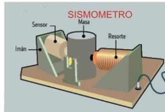
El SISMÓMETRO capta las ondas sísmicas generadas al interior del volcán, y el REGISTRADOR las graba. En laboratorio, el sismólogo se encarga de descifrar su procedencia.
