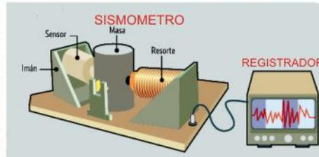
El SISMÓMETRO capta las ondas sísmicas generadas al interior del volcán, y el REGISTRADOR las graba. En laboratorio, el sismólogo se encarga de descifrar su procedencia.
