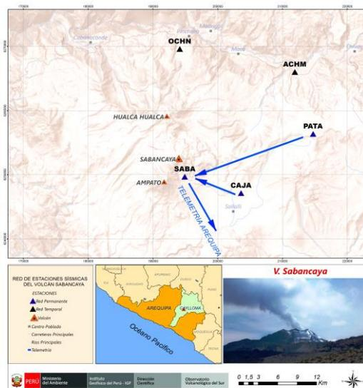
**Figura 1.-** Red de estaciones sísmicas-telemétricas del volcán Sabancaya (triángulos azules). Adicionalmente, se ha instalado 3 estaciones temporales (triángulos negros) en la zona muy próxima al cráter. Además de estas estaciones, el IGP dispone de 12 estaciones sísmicas en tiempo real en la región.
