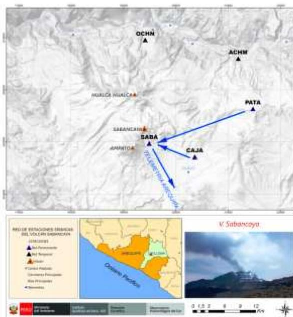
*Figura 1.- Red de estaciones sísmicas-telemétricas del volcán Sabancaya (triángulos azules). Adicionalmente, se ha instalado 3 estaciones temporales (triángulos negros) en la zona muy próxima al cráter. Además de estas estaciones, el IGP dispone de 12 estaciones sísmicas en tiempo real en la región.*
