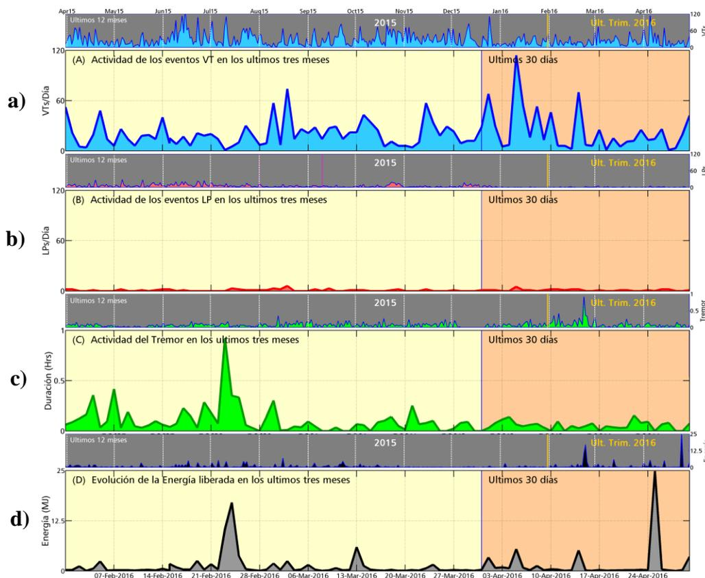
**Figura 2.-** Evolución anual, trimestral y quincenal de la sismicidad del volcán Misti, hasta el 30 de abril del 2016, donde: a) VTs, b) LPs, c) Duración del Tremor y la d) Energía sísmica total diaria.
