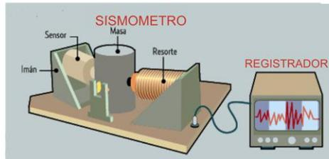
El **SISMÓMETRO** capta las ondas sísmicas generadas al interior del volcán, y el **REGISTRADOR** las graba. En laboratorio, el sismólogo se encarga de descifrar su procedencia.
