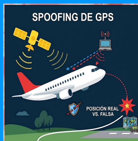
Figura 3. Diagrama de ataque o interferencia de tipo spoofing a señales GNSS (especificado por GPS en el diagrama).
