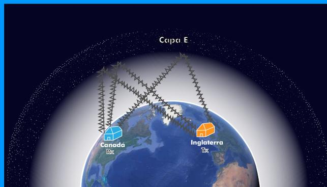
Figura 2. Esquema de la primera transmisión trasatlántica de radio hecha por Guglielmo Marconi en 1901 desde Reino Unido hasta Canadá, usando la capa E como medio reflector.
