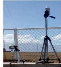
2 Radar perfilador de nubes y precipitación (MIRA 35C)
